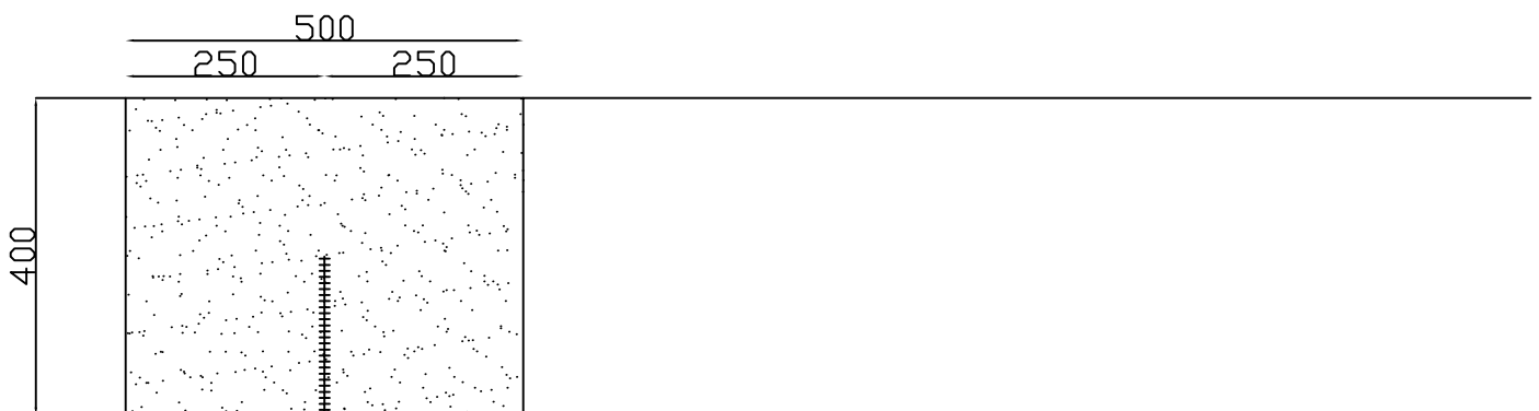
Fig. 2 - Scavo trasversale alla carreggiata
