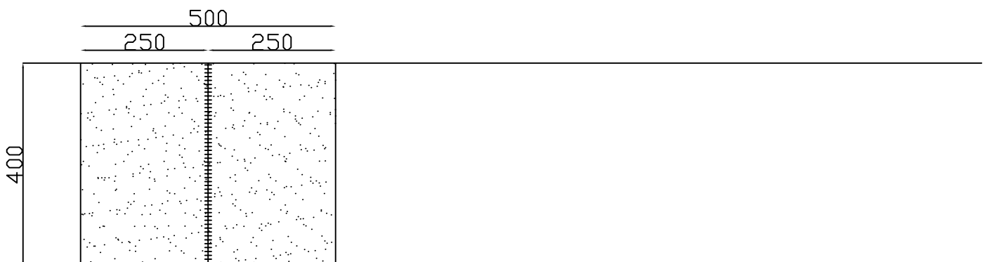
Fig. 3 - Scavo trasversale alla carreggiata
